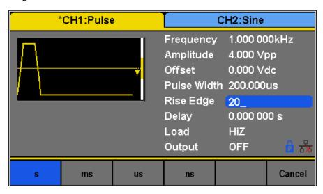
Figure 15 - Rise Edge of a Pulse
